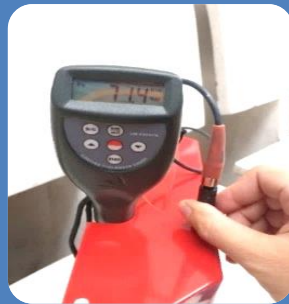
MÁY ĐO ĐỘ DÀY LỚP PHỦ THICKNESS GAUGE
