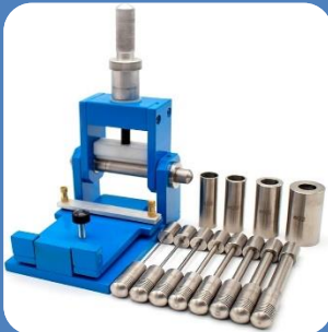
UỖN CONG LĂNG TRỤ CYLINDRICAL BEND TESTER
